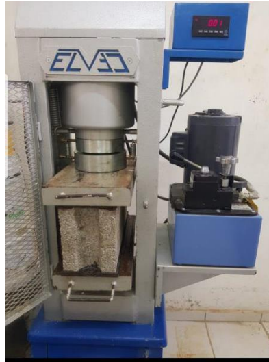
Figura 17 Ensayo de la pieza ecológica a la compresión simple
