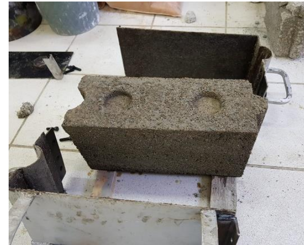
Figura 15 Pieza de mampostería ecológica para muros no estructurales
