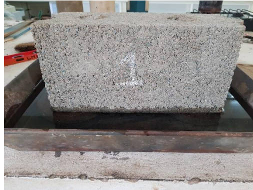
Figura 18 Prueba de absorción máxima inicial de la pieza ecológica
